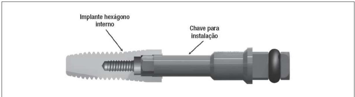
Figura 02: Implante com conexão hexágono interno (de Aislan, 2009).
